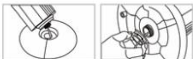
C) DEN UNTEREN TEIL DES LÜFTERS ANSCHLIESSEN UND SCHLIESSEN SIE DAS KABEL AN. D) DAS KUNSTSTOFFMATERIAL VERLÄNGERN
