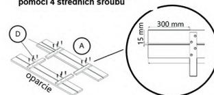
6 pak pomocí velkých pantů spojte lavici s opěradlem tak, aby dlouhé desky byly na spodní straně
