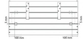
8. Csavarozzuk össze a négy megmaradt deszkát a prizmákkal együtt a felső részhez, amelyet a pad rögzítése után a homokozó oldalához rögzítünk.
