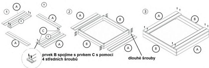
4 prvek A spojíme s prvkem C pomocí 4 středních šroubů
