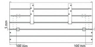
8 ze čtyř zbývajících prken sešroubujte pomocí hranolů horní část, která se po zajištění lavic připevní k boku pískoviště
